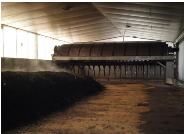
一次発酵槽ロータリー攪拌機
